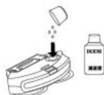
③用量杯加入约2.5ml清洁液或加入约十分之一瓶盖的容量
